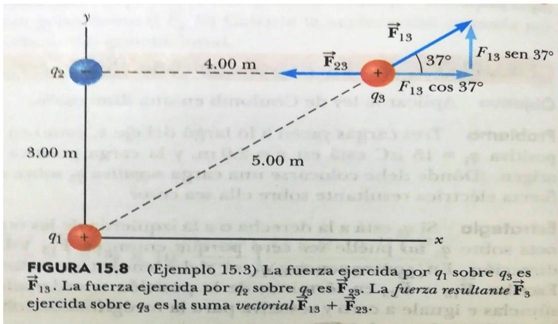
**FIGURA 15.8** (Ejemplo 15.3) La fuerza ejercida por  $q_1$  sobre  $q_3$  es  $\vec{F}_{13}$ . La fuerza ejercida por  $q_2$  sobre  $q_3$  es  $\vec{F}_{23}$ . La fuerza resultante  $\vec{F}_3$  ejercida sobre  $q_3$  es la suma vectorial  $\vec{F}_{13} + \vec{F}_{23}$ .
