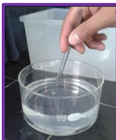
**LIBERACIÓN DE GASES:** Uno de los productos de una reacción química puede ser una sustancia gaseosa. En la imagen, la efervescencia resulta de la liberación de dióxido de carbono ( $\text{CO}_2$ ).
